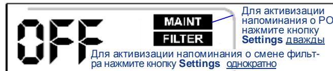
Рис. 18. Непрерывный режим вентилятора По умолчанию напоминания отключены. Выбор интервалов напоминания - кнопками Вверх/Вниз (▲▼) .
